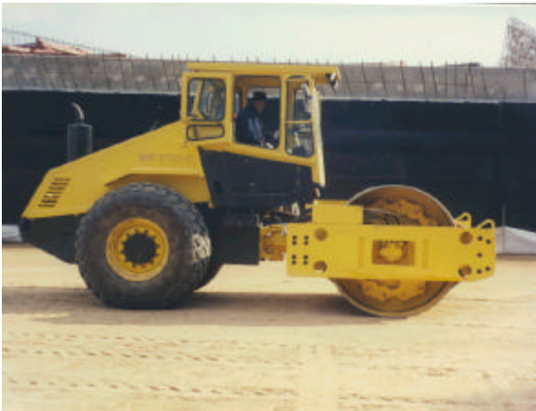
사진 6.1 다짐에 사용된 장비 (독일 BOMAG사 모델명 : BW213D)
