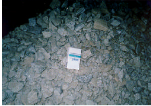
사진 6.4 교대 뒤펅재(배수재)로 사용된 골재의 모습
