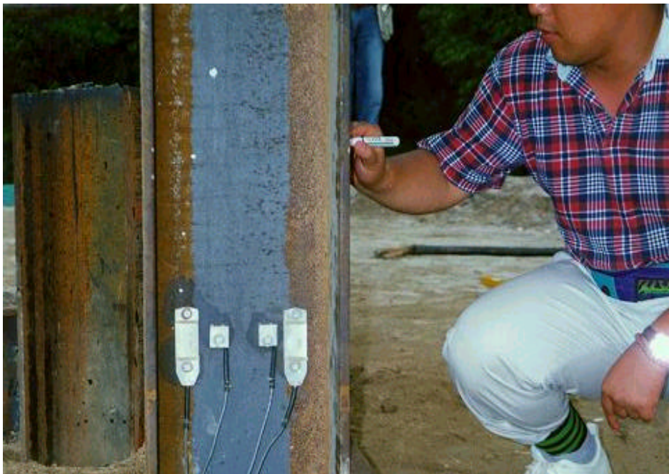
사진 A.26 동재하시험을 위한 계측기 부착 모습
