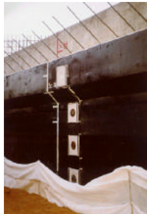
사진 6.7 토압계가 부착된 교대 벽체의 모습(교대 1)
